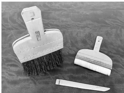
【図9】 打ち刷毛と付け回し刷毛、へら
